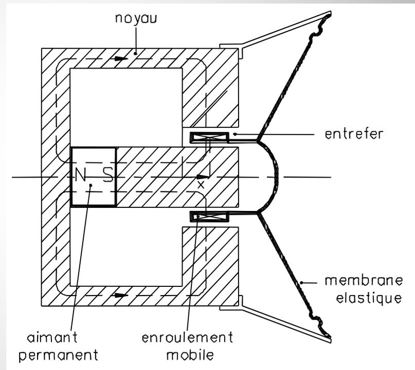
On appellera **transducteurs** un composant qui fournit comme signal de sortie une grandeur physique utilisable en réponse à une autre grandeur physique spécifiée comme signal d'entrée :
