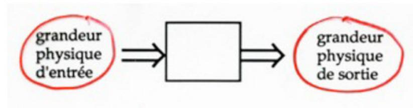
• les **capteurs, senseurs ou détecteurs** qui fournissent comme signal de sortie une quantité électrique utilisable en réponse à une grandeur, une propriété ou une condition physique à mesurer
